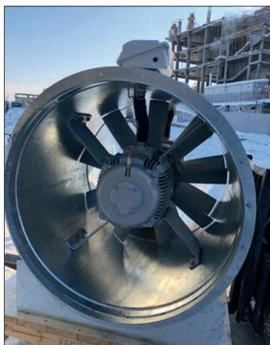
■ Рис. 5. Двухступенчатый реверсивный вентилятор дымоудаления
