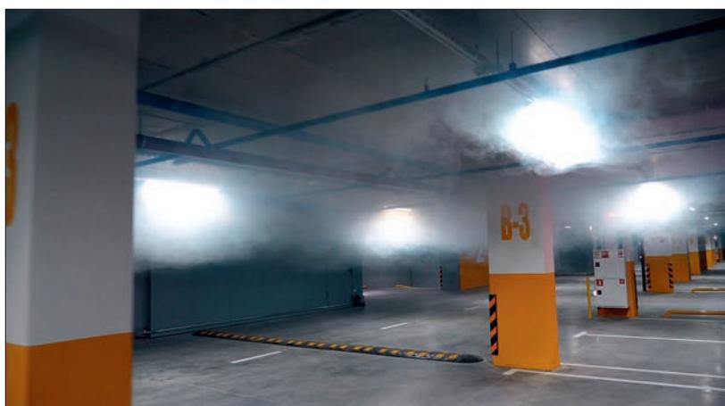
Рис. 9. Испытания горячим дымом: проверка возможности удержания нижней границы дыма за счет притока наружного (холодного) воздуха
